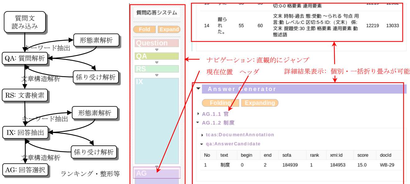
図 3. 質問応答システムのコンポーネント構成例 (左) と質問応答システム処理結果の HTML 視覚化例 (右)。
